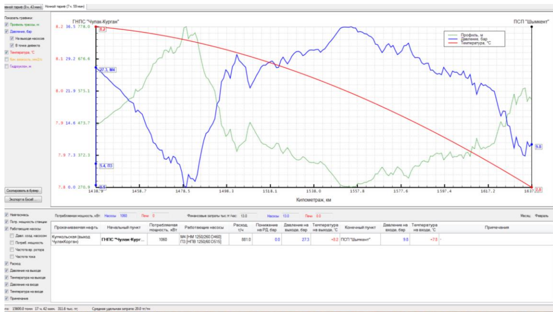
Рисунок 5.15. Расчетные данные (ночной тариф) на участке «Чулак-Курган - Шымкент» за февраль, параметры на выходе ГНПС «Чулак-Курган»: T_{\text{ВЫХ}} = 8.2 \text{ }^{\circ}\text{C} , G = 881 \text{ т/ч}
