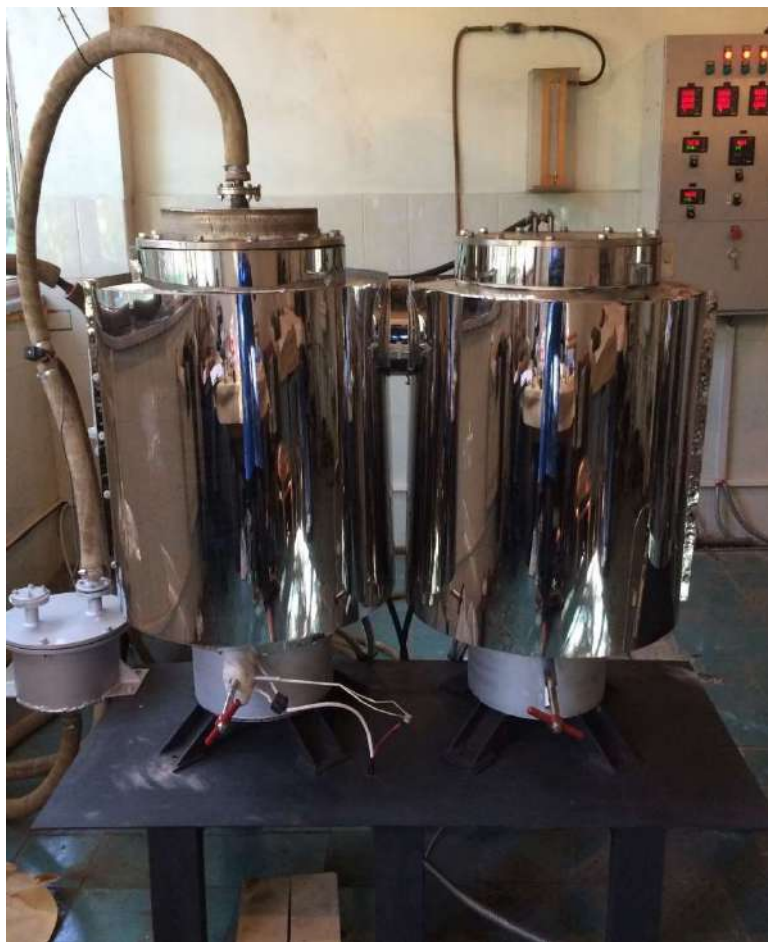
Рис. 4.9. Установка для рафинирования селена с инерционной очисткой паровой фазы
