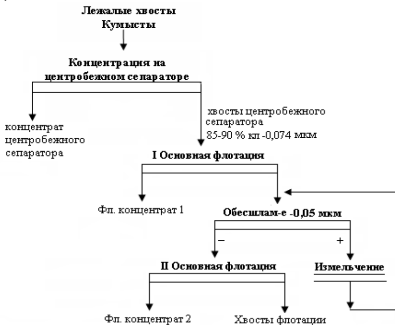
Рисунок 7.25. Схема гравитационно-флотационного обогащения хвостов Кумыстинского месторождения
