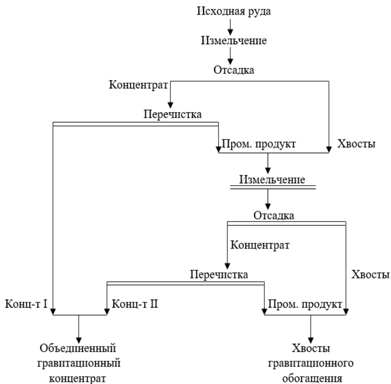
Рисунок 5.4. Схема проведения опытов по обогащению руды месторождения «Акбакай»
