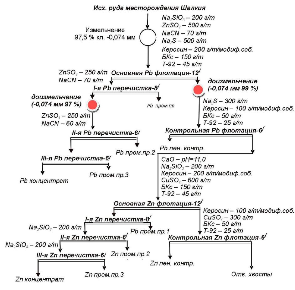
Рисунок 2 – Технологическая схема и реагентный режим флотации руды месторождения Шалкия с применением доизмельчения и модифицированного реагента
