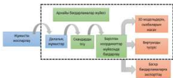
Сурет 3 - Лазерлік сканерлеу бойынша жұмыстарды жүргізу кезектілігі
