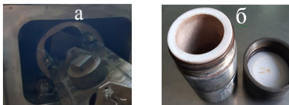
Рисунок 2 - Автоклавная установка (а), автоклав с фторпластовым стаканом (б)
