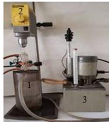
1-термостатированная ячейка с холодильником, 2 – мешалка с регулируемым числом оборотов, 3 – термостат
