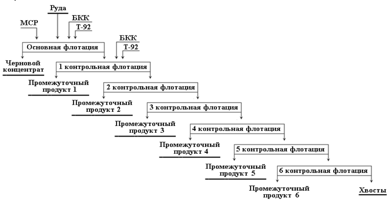
Рисунок 3 Технологическая схема по кинетике контрольной флотации
