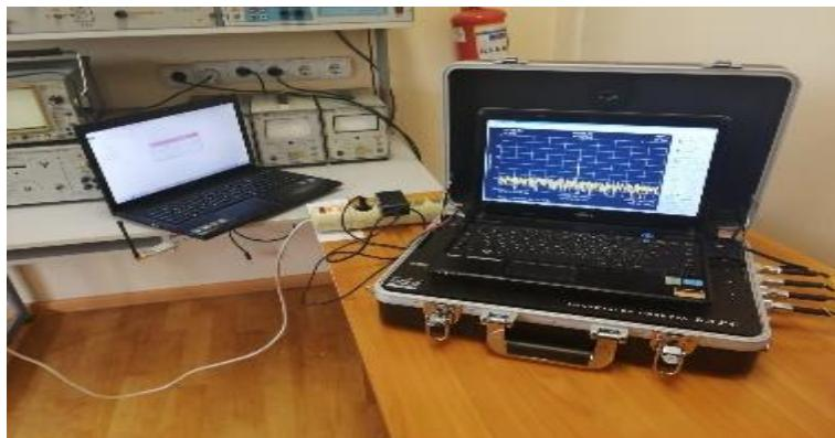
**Рисунок 1** – Пример измерения уровня мощности сигнала частоты 2400 МГц от USB-генератора на анализаторе спектра БАРС
