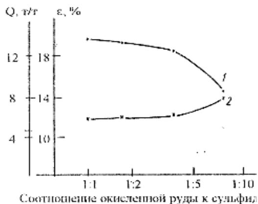
Рис. 45. Извлечение меди (1) и расход серной кислоты (2) в зависимости от соотношения оксидной и сульфидной частей руды
