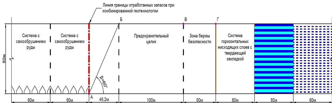
Рисунок 4 Схема бермы безопасности и предохранительного целика от влияния очистных работ при подземной добыче хромитов с применением комбинированной геотехнологии на глубоком горизонте шахт «ДНК» ДонГОКа
