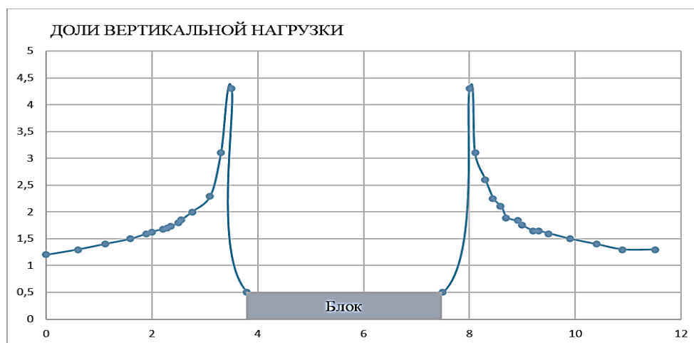
Рисунок 2 Распределение опорного давления в окрестности блока
