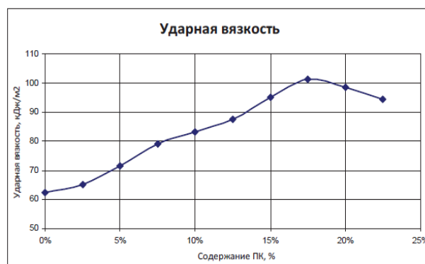
Рисунок 7. Зависимость ударной вязкости композиционного материала от концентрации ПК [15]
