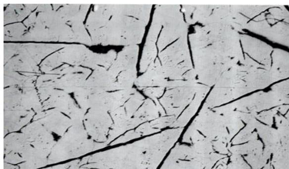
Рисунок 1 – Чугун с включениями и микротрещинами
