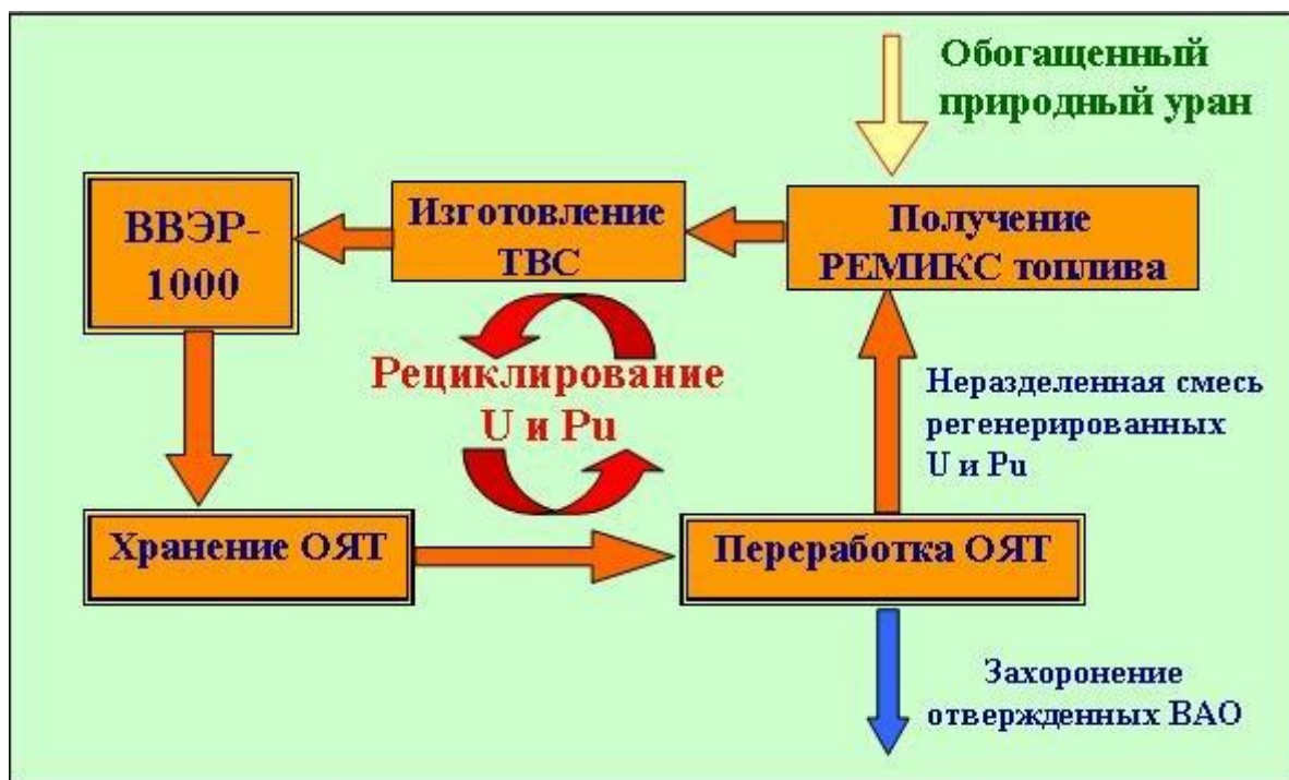
Рисунок 7 – Схема многократного рециклирования регенерированного урана и плутония в виде РЕМИКС-топлива в реакторах ВВЭР-1000
