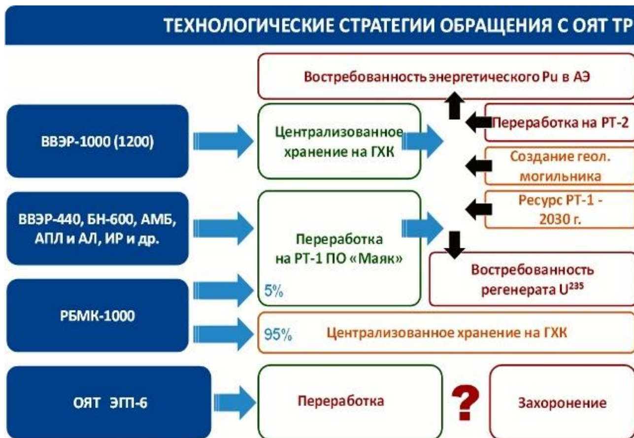
Рисунок 1 – Схема обращения с ОЯТ различных видов
