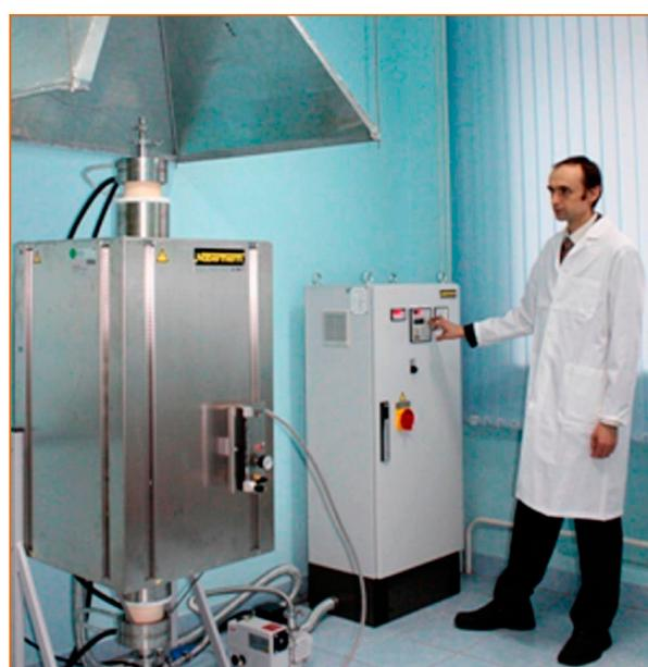
Работа на вакуумной трубчатой печи
