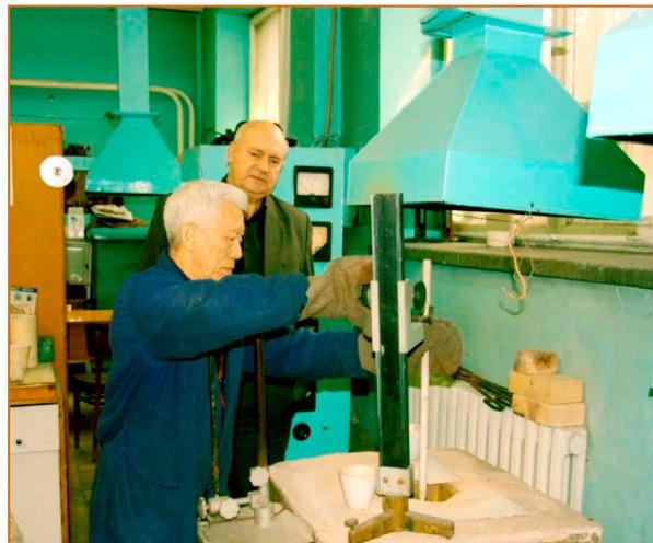
Опыт по использованию флюсов при плавке медных концентратов
