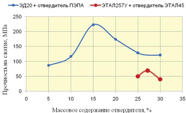
Рисунок 1 – Зависимость прочности двух марок эпоксидной смолы в зависимости от содержания отвердителя
