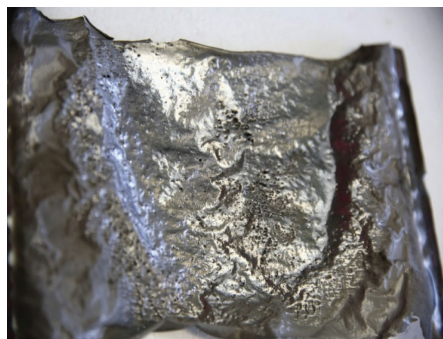
а – Та, 40 мкм, расстояние от мишени 50 мм
