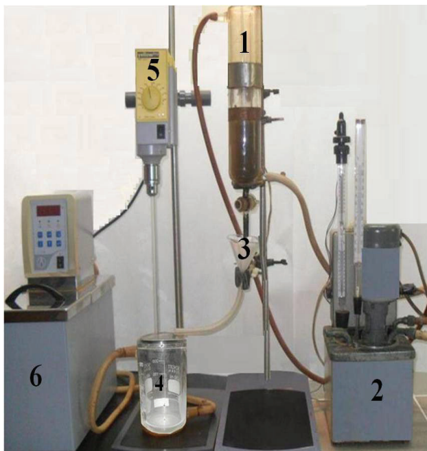
1 – термостатированная ячейка со стеклянной мешалкой для растворения ТПА; 2, 6 – термостаты с регуляторами температуры; 3 – химическая воронка со складчатым бумажным фильтром, 4 – термостатированная ячейка для кристаллизации ЧПА; 5 – механическая мешалка с регулируемым числом оборотов.
