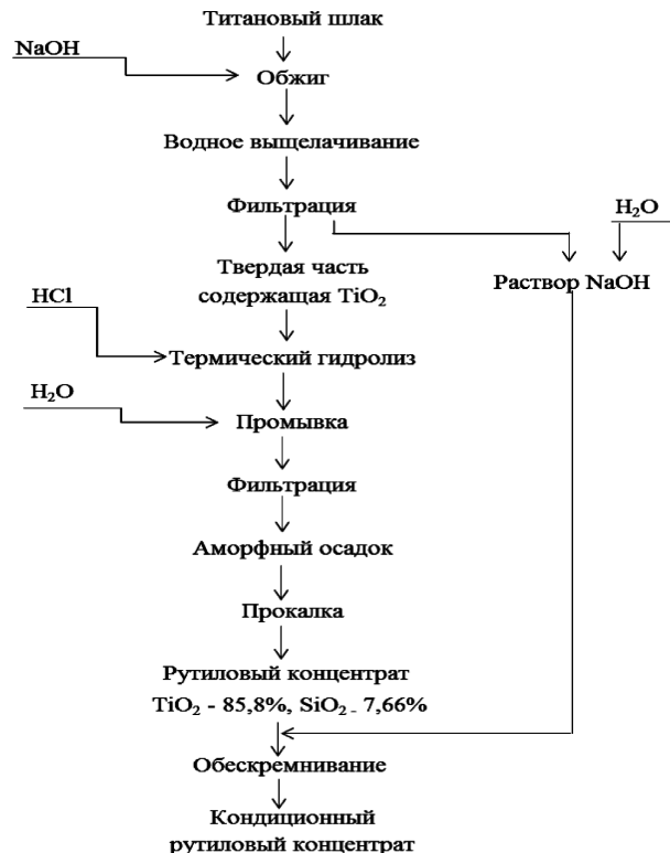
Рисунок 3 – Принципиальная технологическая схема получения кондиционного рутилового концентрата из титанового шлама
