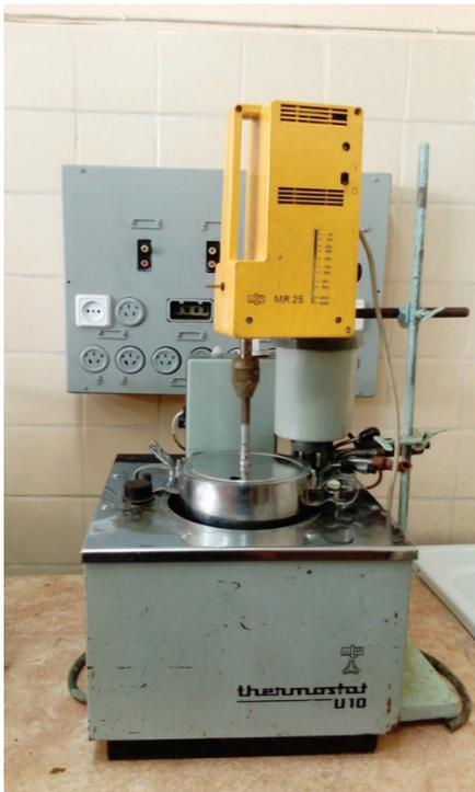
Рисунок 4 – Укрупненно-лабораторная установка для выщелачивания конвертерного шлама
